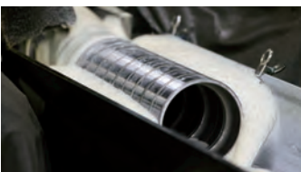
ベアリング外輪の外径研磨工程
