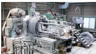
製鋼メーカーから調達した線材を自社伸線
