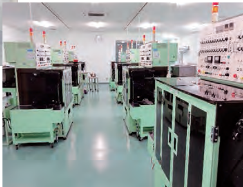
鋼球表面の傷や汚れ、光沢不良を検査する外観検査工程
