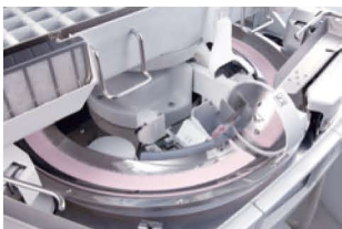
高い分包精度を誇るR円盤機構
