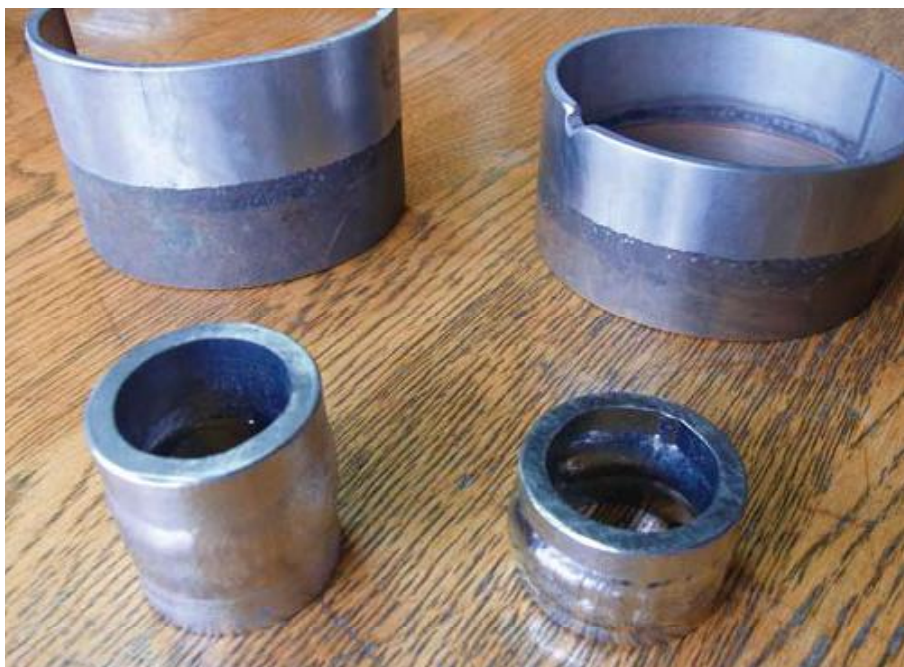
異種金属間を溶接した製品（奥）とチタン間を溶接した製品（手前）
