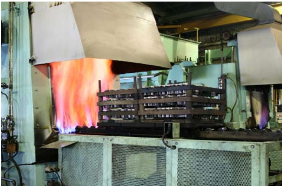
強度の必要な重要保安部品の多くには、熱処理が施されている
