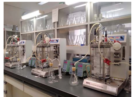
卓上型培養装置 (丸菱バイオエンジ製)
