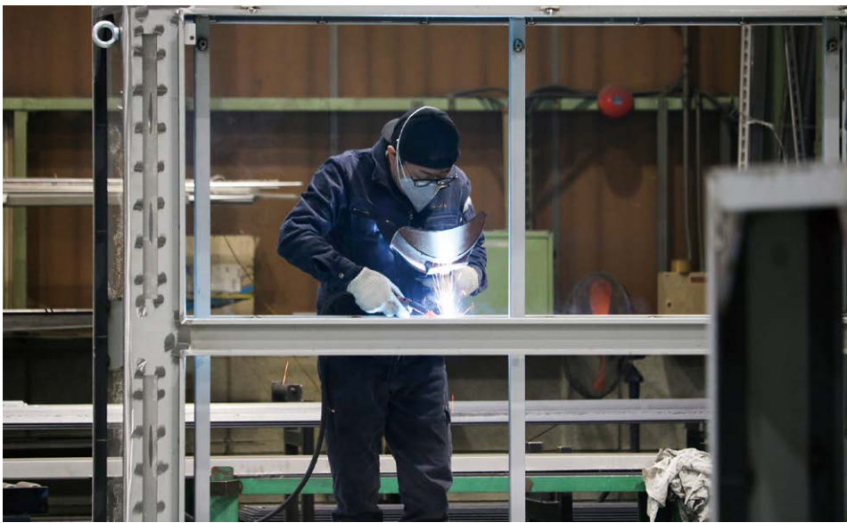
浄水場向けの屋外制御盤の溶接
