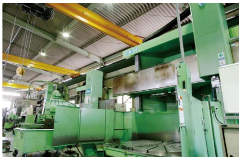
外径3mの大物加工に対応する立型CNC旋盤
