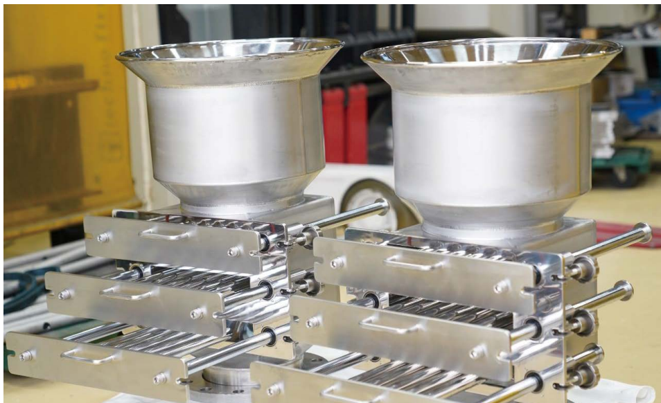
SUS304 で製作した磁選機
