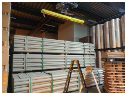
新たな挑戦だった長さ5mの紙管
