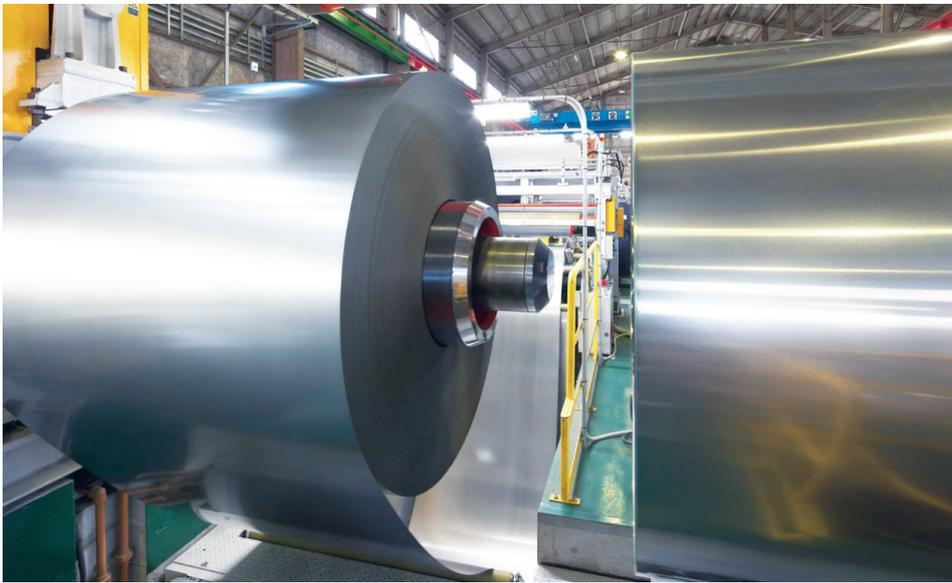
スリット加工前の電磁鋼帯
