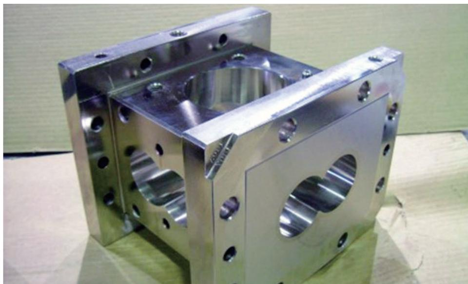
二軸シリンダを高精度で仕上げる
