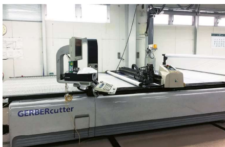
自動裁断を行うCAMと自動裁断機
