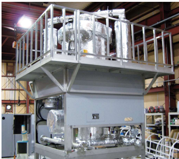
本社工場で製造する浄化処理装置
