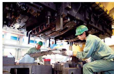
試し打ちで、金型の機能を確認
