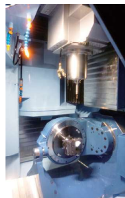
松浦機械製作所製5軸マシニングセンタ(右)と機械内部
