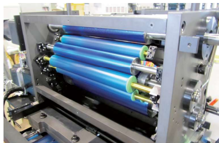
ロール使用のインキングユニット
