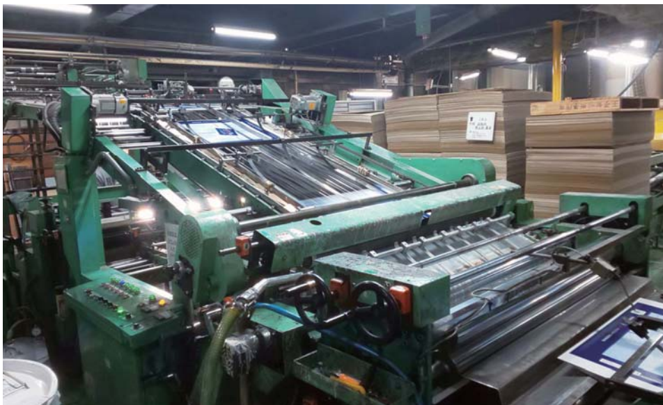
印刷と片面段ボールを貼り合わせる機械
