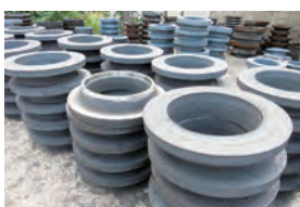
ローリング鍛造で加工した段付きリング
