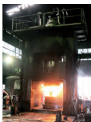
鍛造前の荒加工などに用いる油圧プレス
