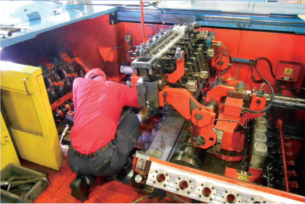
高精度な加工を可能にするパーツフォーマー（冷間鍛造機）
