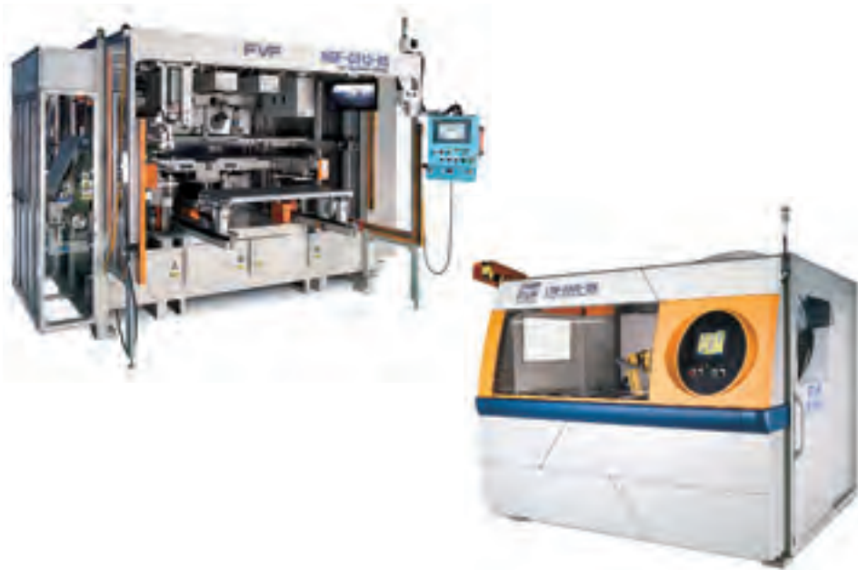
真空孔なしの型で成形できる「NGF成形機」と、トリミングマシンの「LTMシリーズ」
