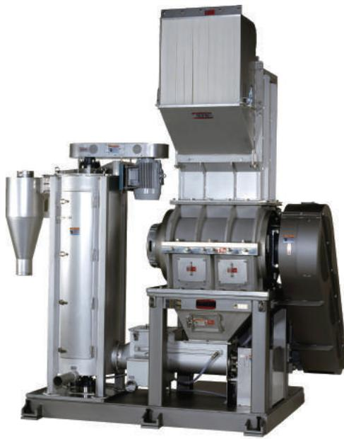
廃プラの粉碎・洗浄・脱水処理装置
